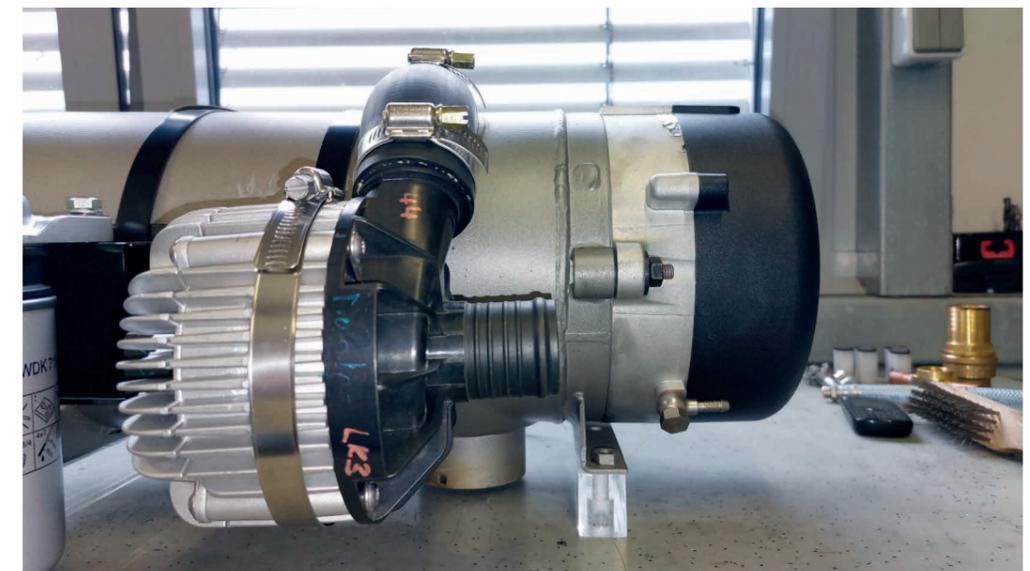
Aktueller Stand: SPump am Heizgerät montiert.
