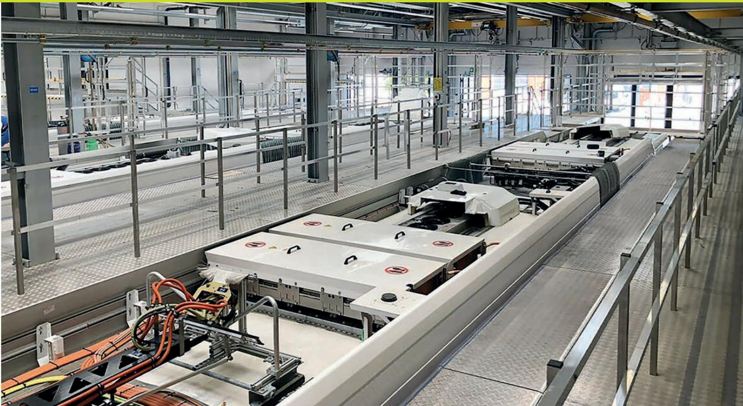
Ansicht der Elektro-Komponenten auf dem Dach eines Elektrobus-Gelenkzuges.
