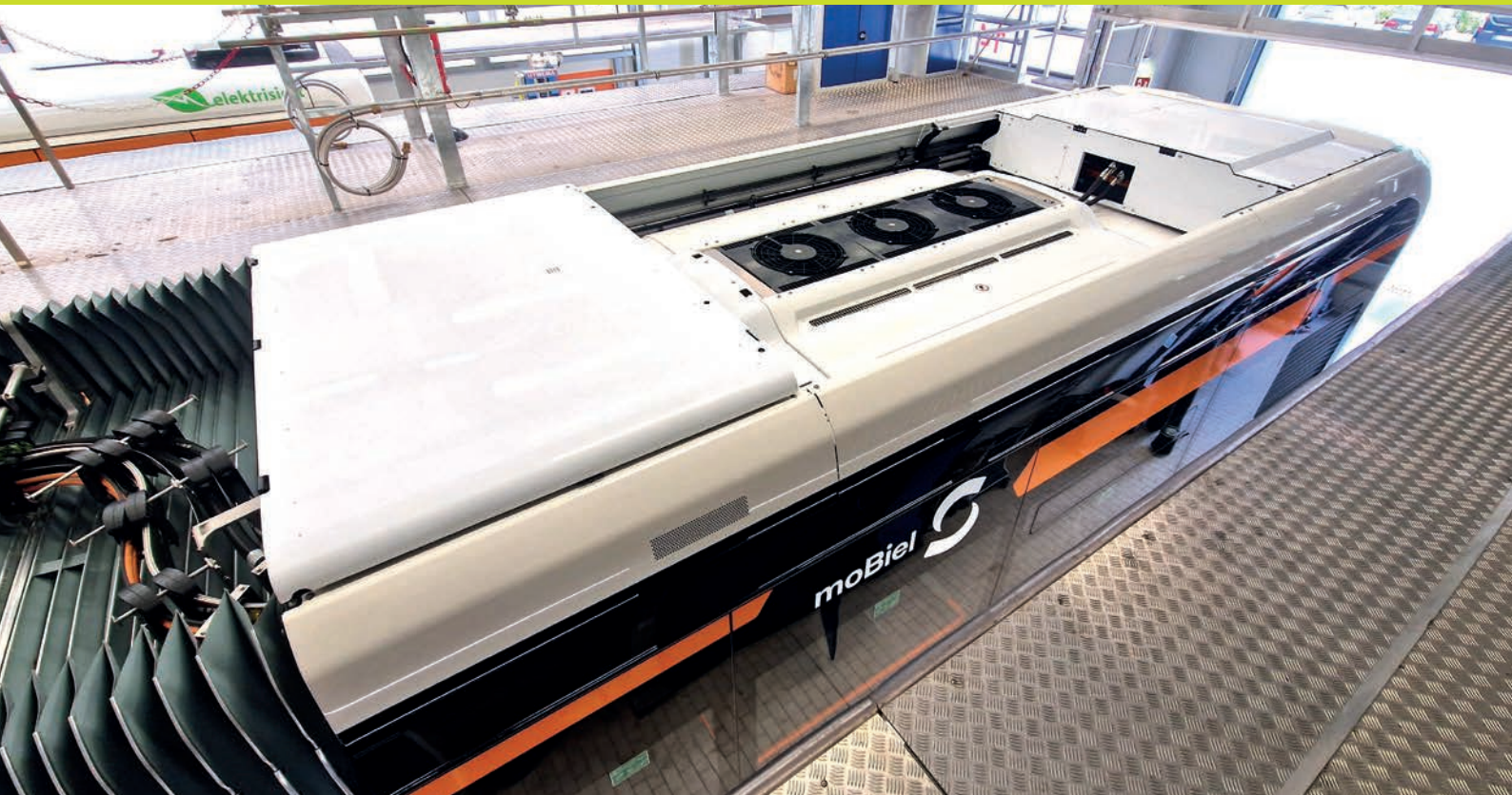
Ansicht des Busdaches mit der Spheros Klimaanlage REVO® HP mit Wärmepumpentechnologie.
